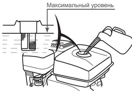
Рис. 8 Максимальный уровень топлива в топливном баке
