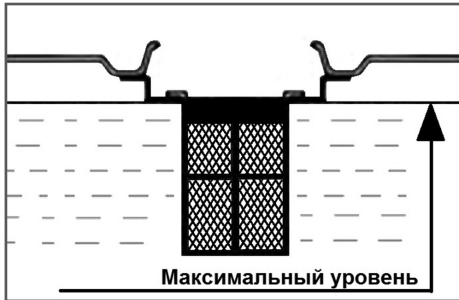
Рис. 8 Максимальный уровень топлива в топливном баке
