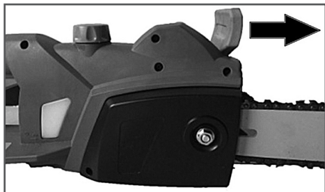
Рис. 8 Включение тормоза цепи
