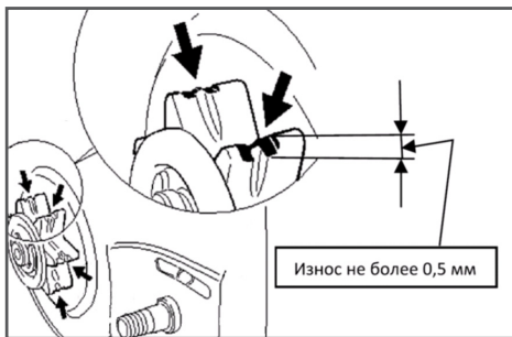
Рис. 14 Проверка износа звездочки
