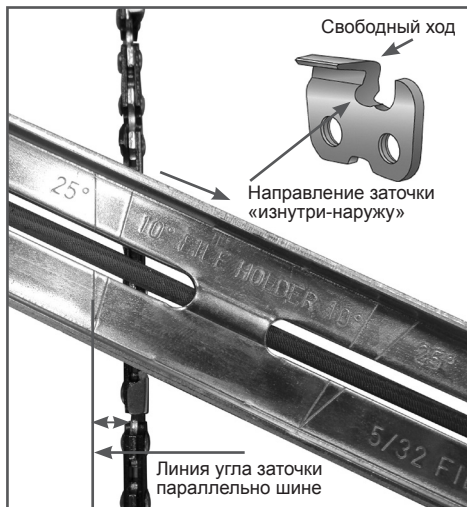
Рис. 16 Определение угла заточки
